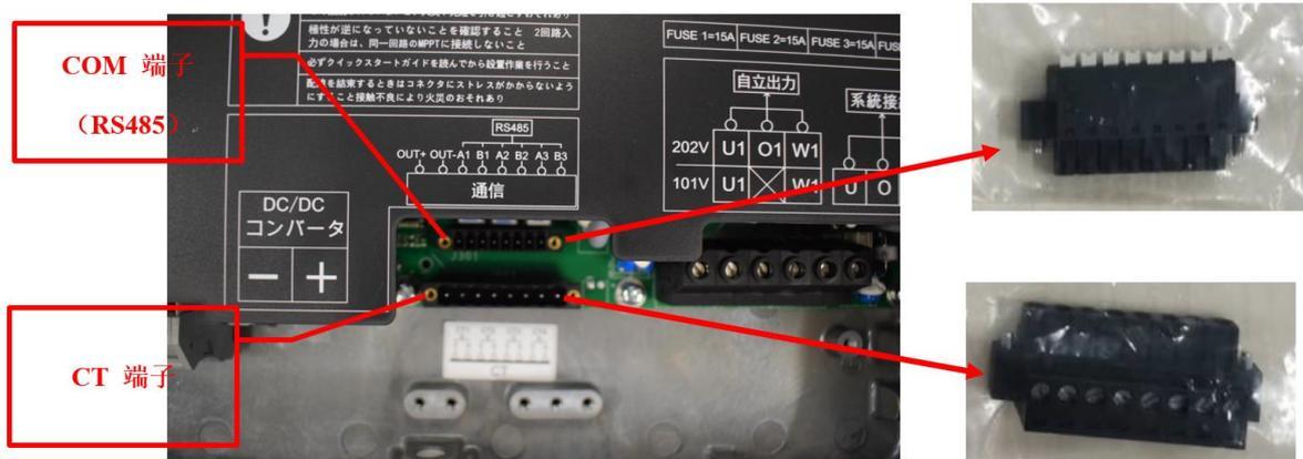
COM 端子 :LUNA、スマートロガーと通信するための接続端子
